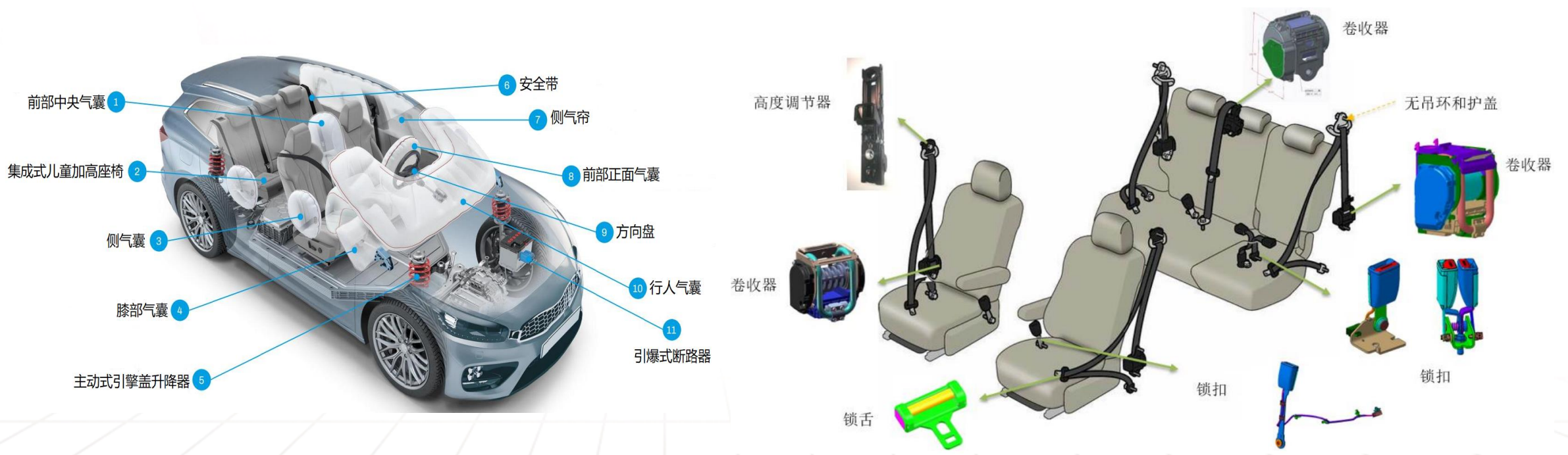
图表3：被动安全零部件整车布局、安全带总成主要部件及安装位置
