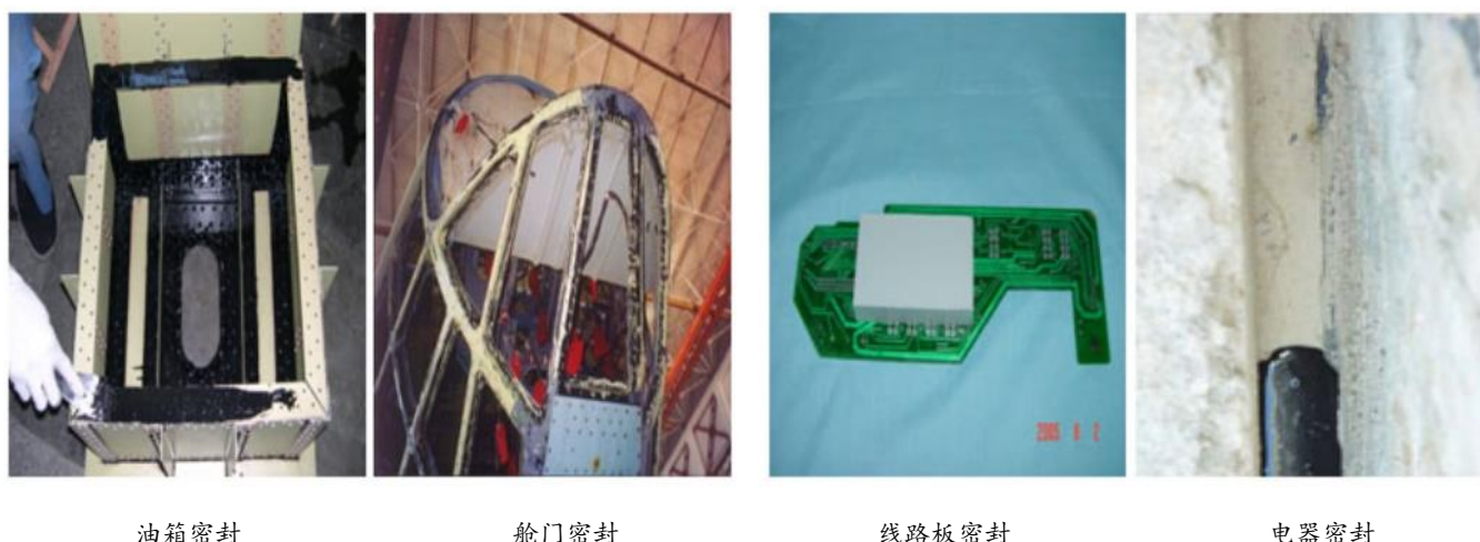
图表40：航材院密封剂的应用示例
