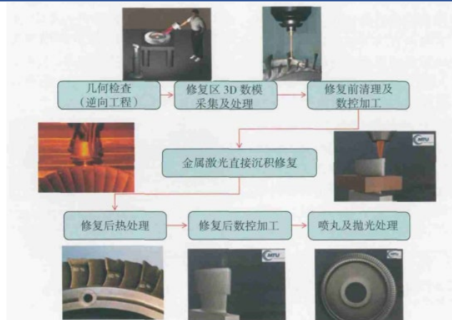
图表 46: MTU 公司整体叶盘激光修复过程流程
