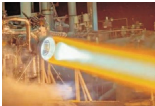
图表 42: 洛克达因公司测试 3D 打印铜合金推力室
