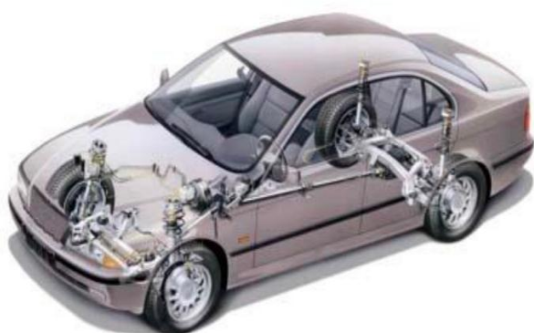
图 8：悬架系统在汽车整车中的位置
