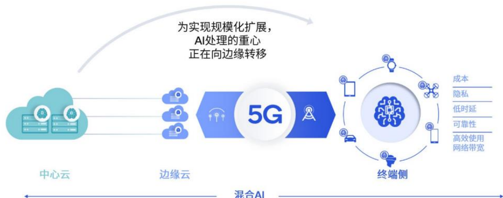
图表2：混合式 AI 部署示意图
