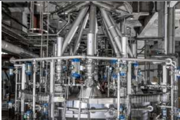
图58：GEA 八角萃取柱年产 7.2 万吨速溶咖啡
