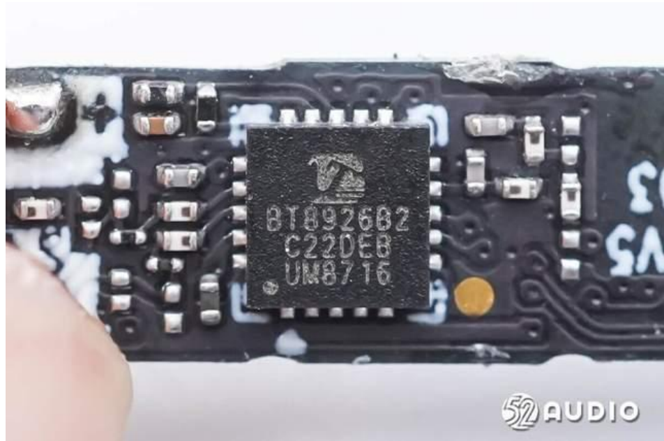
图 7: Redmi Buds 4 活力版真无线耳机拆解 (采用中科蓝讯 BT8926B 蓝牙音频 SoC)
