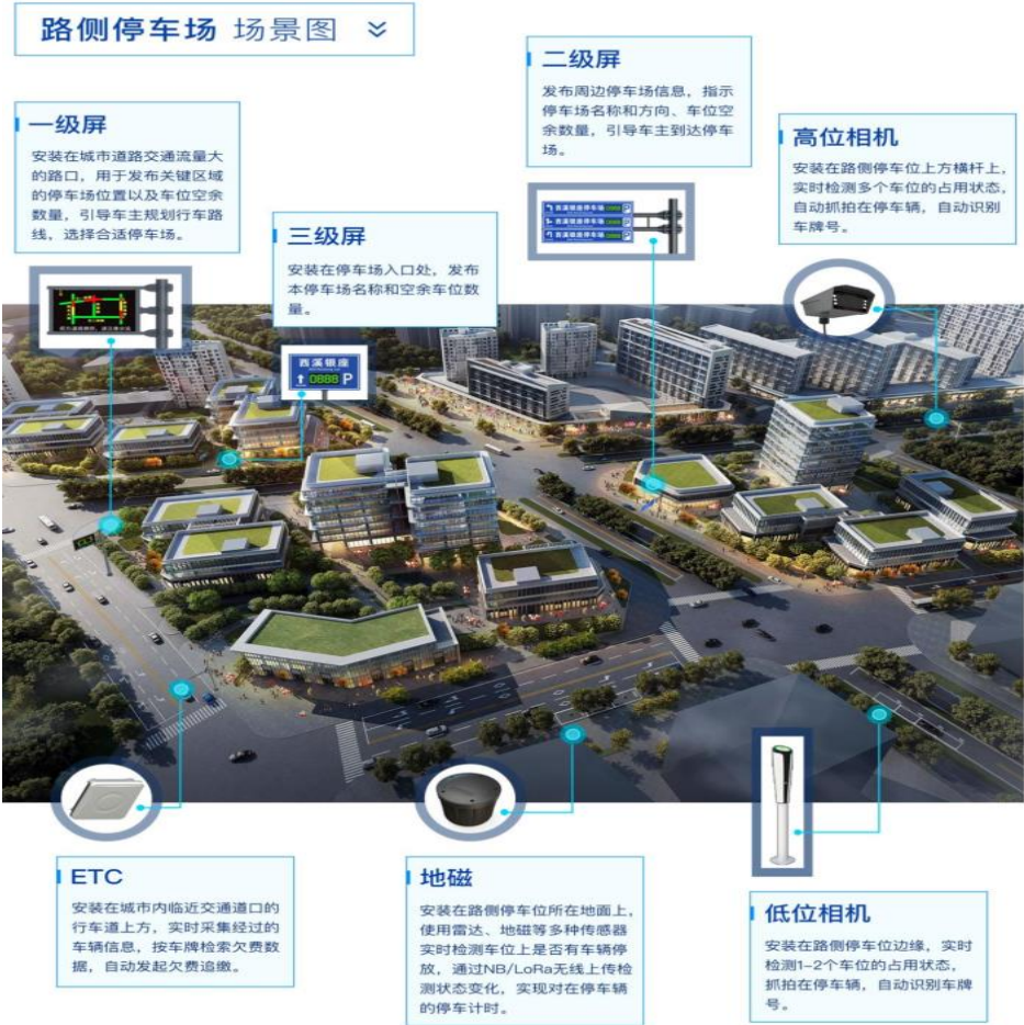
图5：路侧智慧停车系统包括地磁、低位视频和高位视频等不同的系统方案
