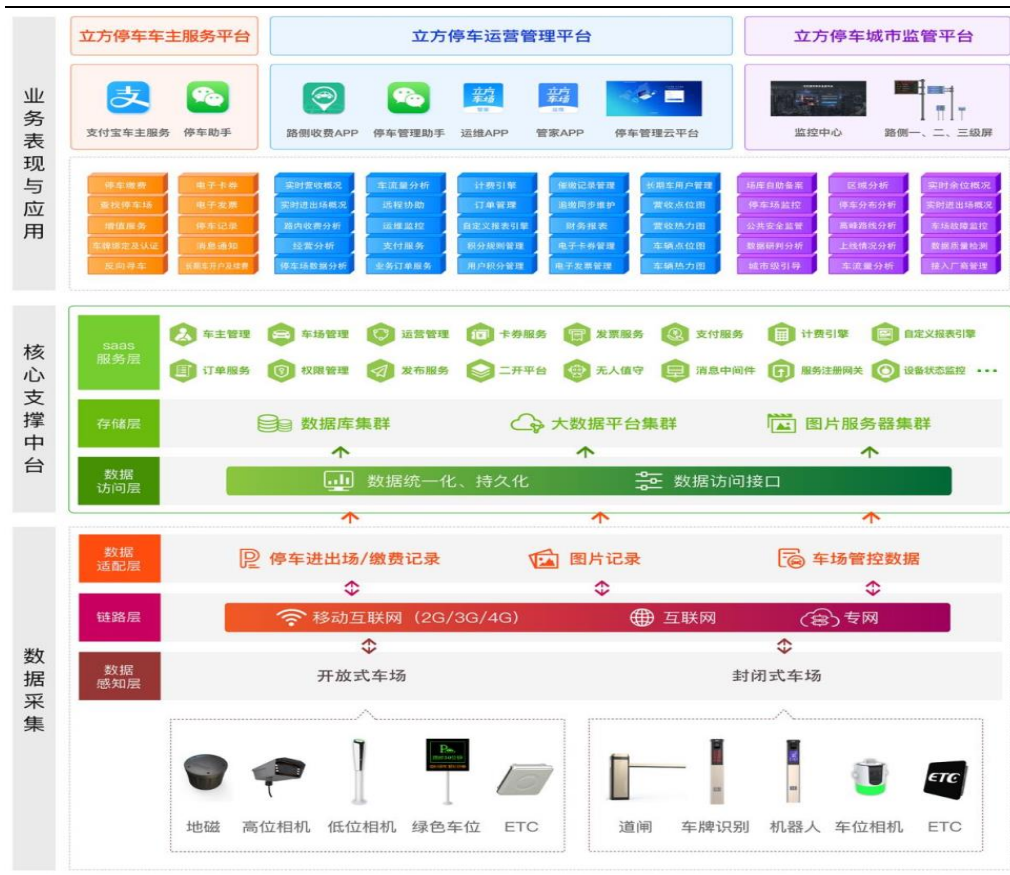
图4：城市级智慧停车系统提供“智能设备+系统平台+运营管理”全产业链产品
