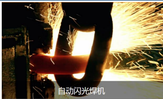
图表 24：自动闪光焊机示意图
