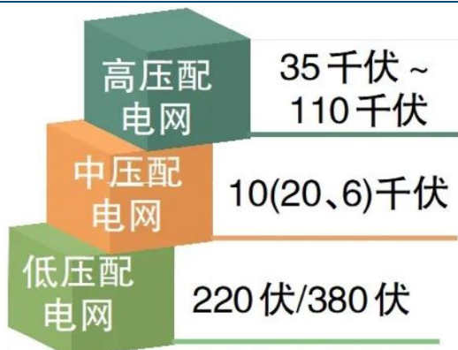
图表26：配电网一般对应电压等级为 110 千伏及以下
