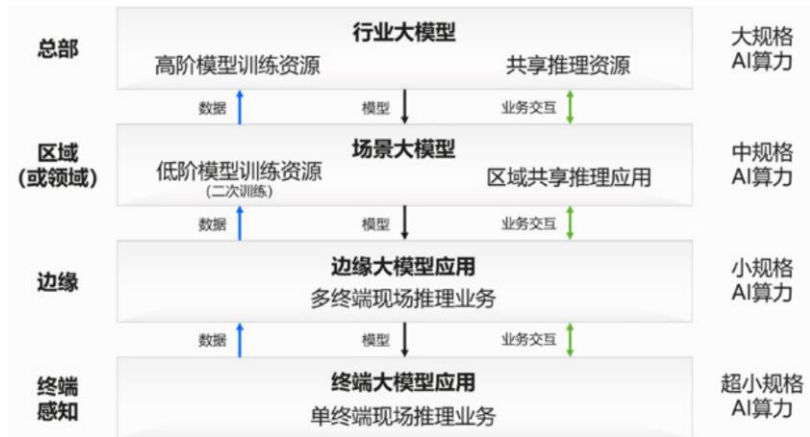
图1: AI 算力基础设施两级训练三级推理的部署范式
