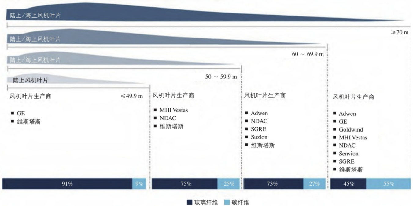
图表 29: 随叶片长度增加碳纤维主梁叶片的占比变化
