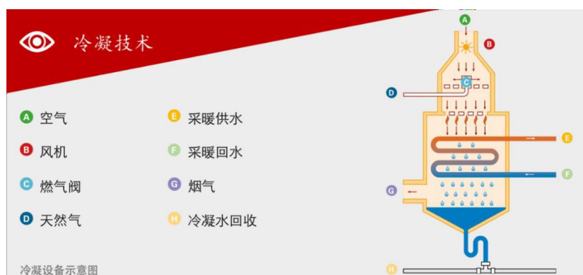
图15：冷凝式燃气壁挂炉是基于常规燃气壁挂炉研发出的新一代产品
