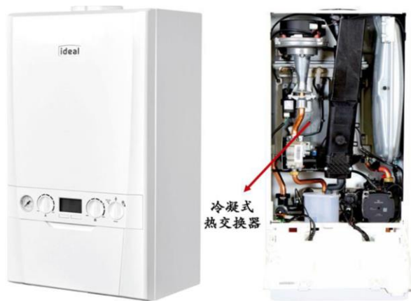
图17：冷凝式热交换器采用一体式设计，整个换热和冷凝过程由一个热交换器完成
