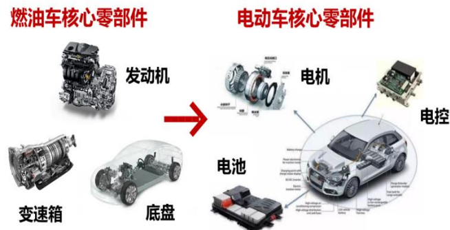
图36 燃油车和电动车核心零部件对比
