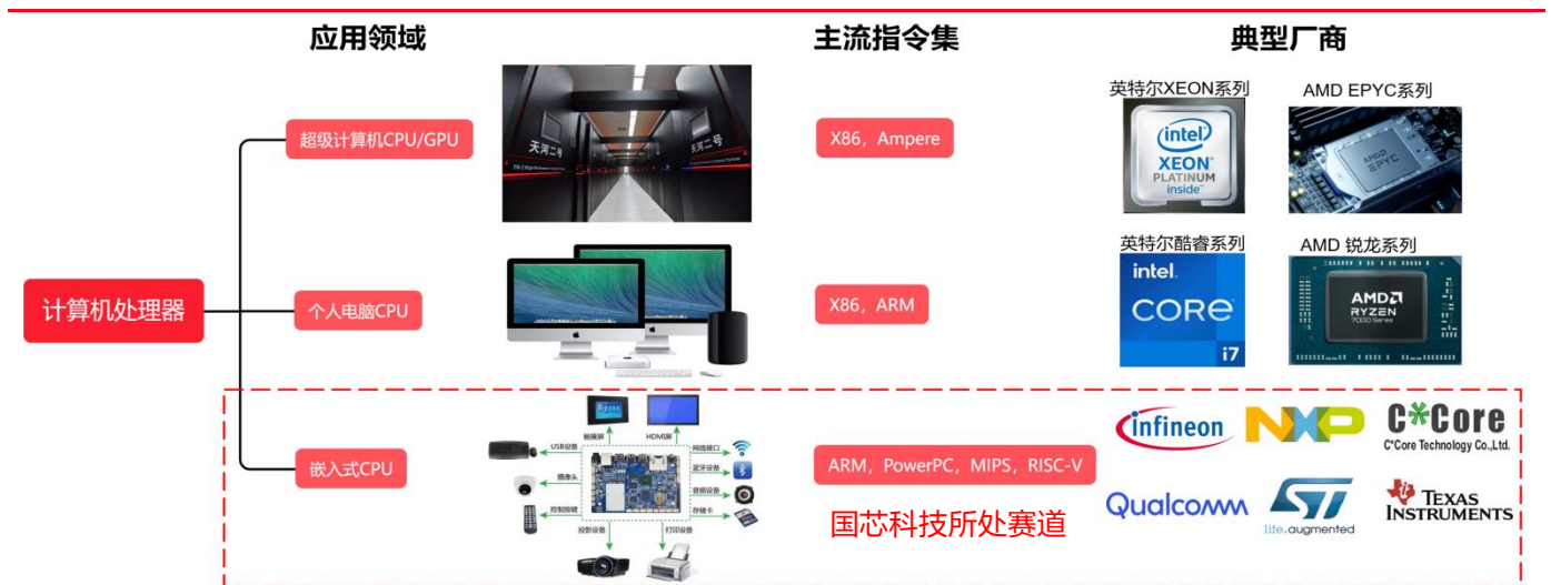
图17 计算机 CPU 的主要类别、内核架构和典型厂商
