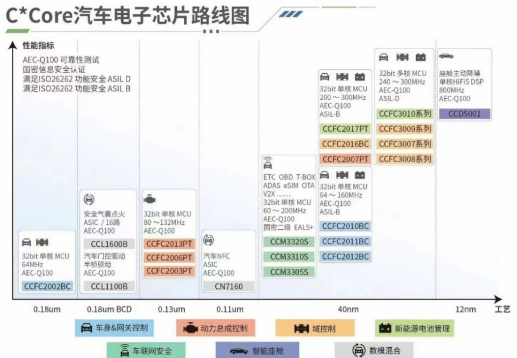
图43 国芯科技汽车电子芯片发展技术路线图
