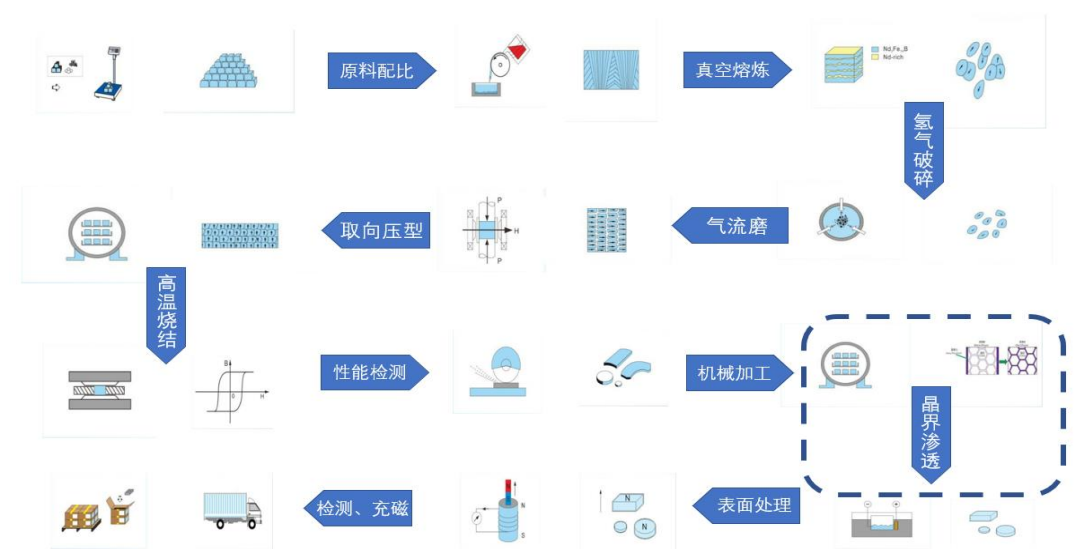
图表20：公司钕铁硼产品生产工艺流程与核心技术
