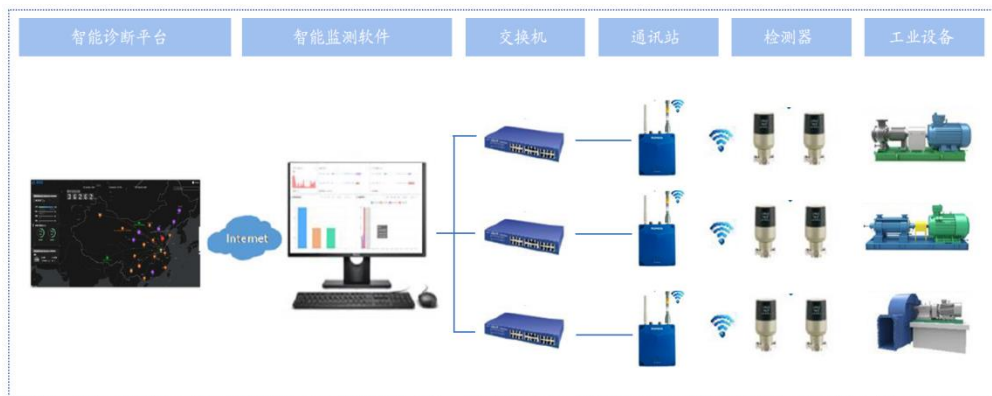
图12：PHM 可实现工程设备健康状态的监测、预测和管理，并显著提升设备使用时长
