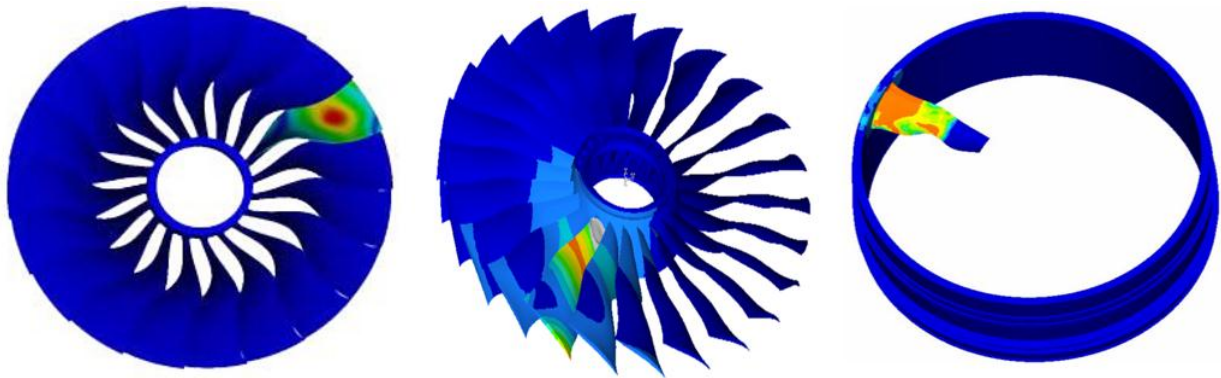
图 17：使用 Virgo 软件进行飞机关键结构鸟撞分析的效果图
