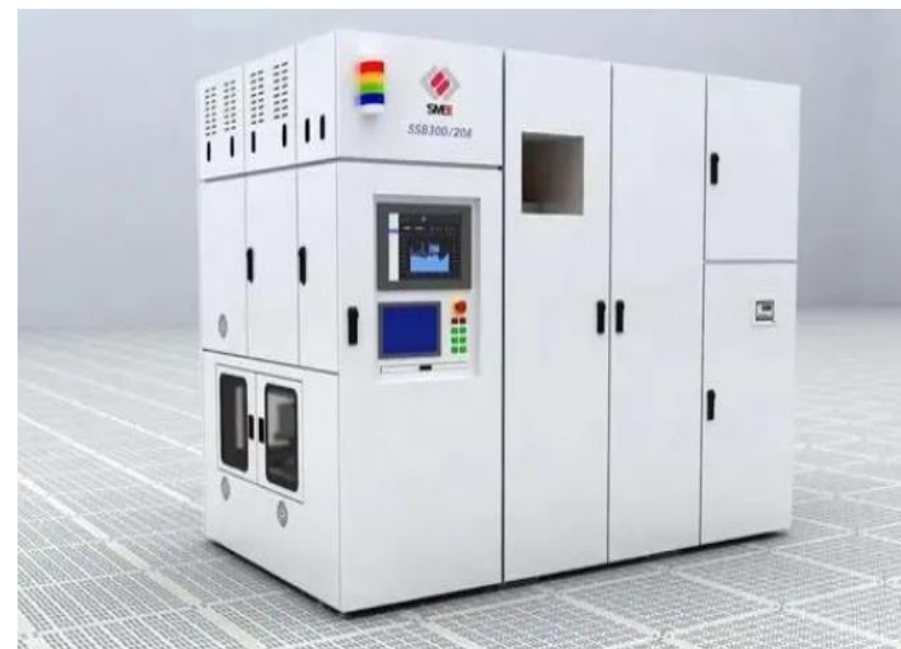
上海微电子自主研发的首台凸块封测光刻机（SMEE）
