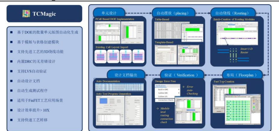
图29: TCMagic 工具测试芯片设计流程图
