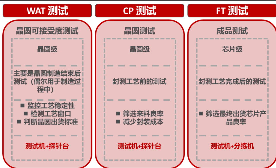
图20：半导体测试分析流程对比
