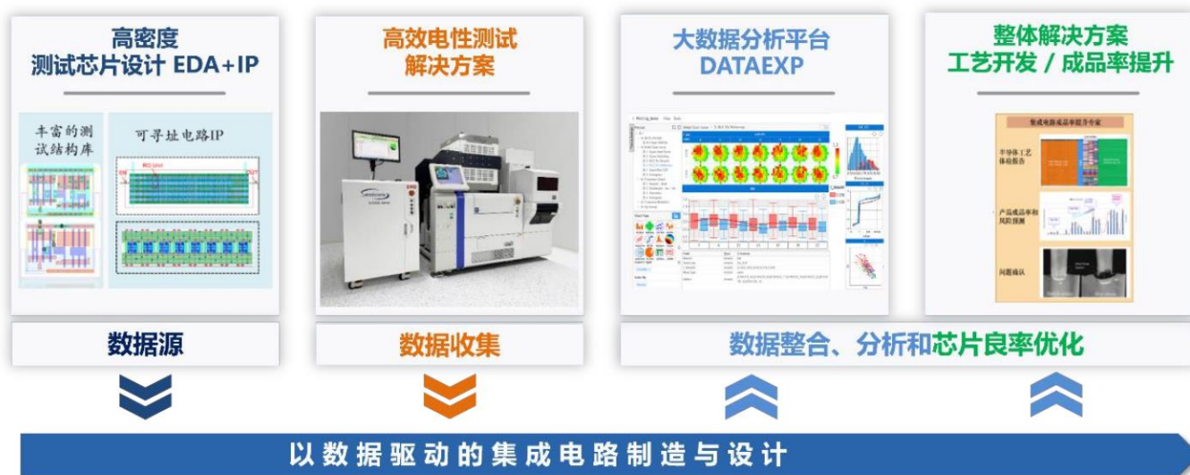
图2：广立微以数据驱动的集成电路成品率提升流程
