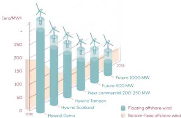
图20: Equinor 规划的漂浮式海上风电成本下降曲线
