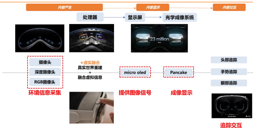
图 3：空间计算平台 Vision Pro 硬件系统框架
