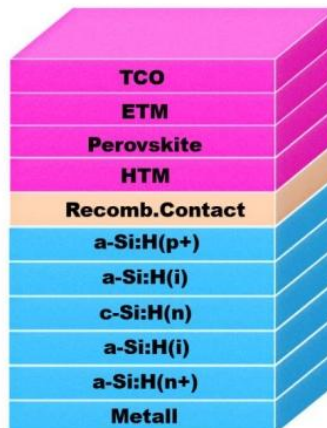
图 22：钙钛矿/晶硅叠层电池两端结构示意图
