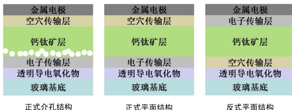
图 20：钙钛矿电池结构示意图
