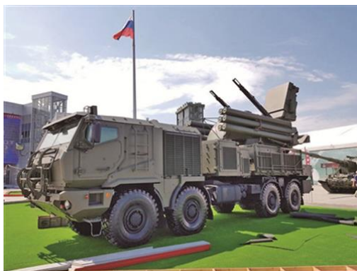
图表32：“铠甲”SM 弹炮合一防空系统
