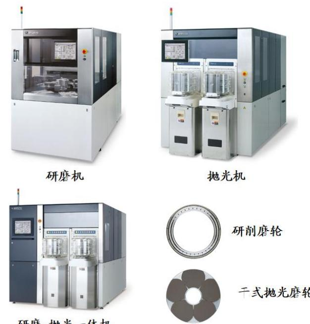
◆ 图：DISCO采用4轴磨削和干法抛光以提高SiC晶片减薄质量
