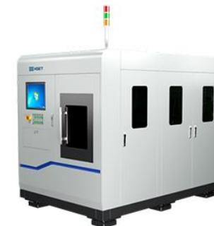
(a) 碳化硅晶圆改质切割设备DSI-S-TC9310
