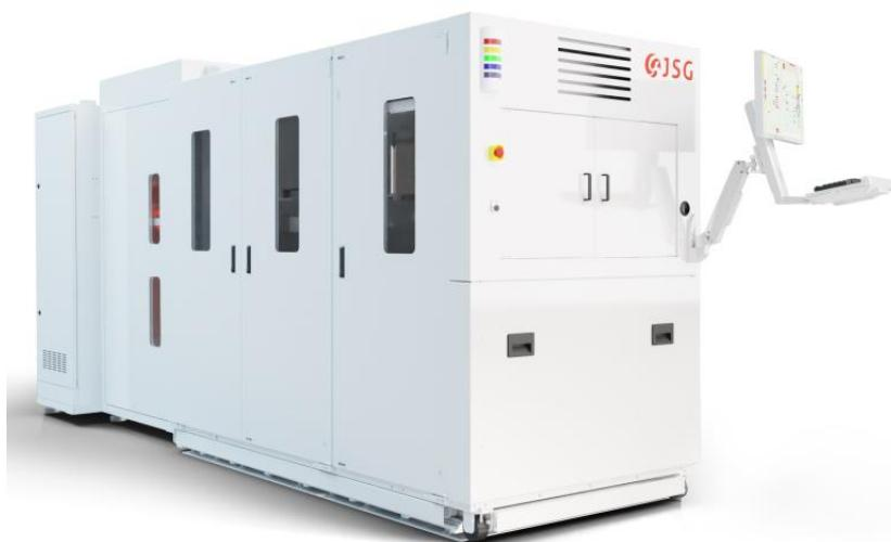
◆ 图：8英寸单片式碳化硅外延生长设备外延的厚度均匀性1.5%以内、掺杂均匀性4%以内，已达到行业领先水平
