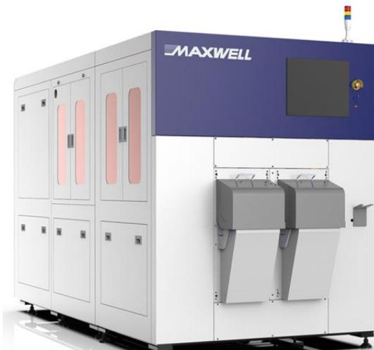
应用于4/6/8英寸碳化硅、蓝宝石等硬质材晶圆的减薄
