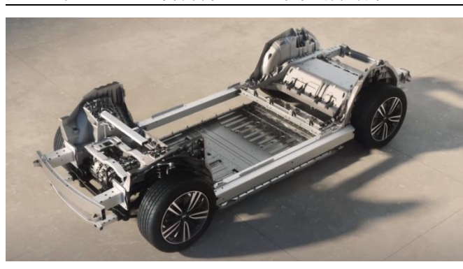
图 61: 小鹏 SEPA2.0 平台采用 CIB 电池车身一体化设计
