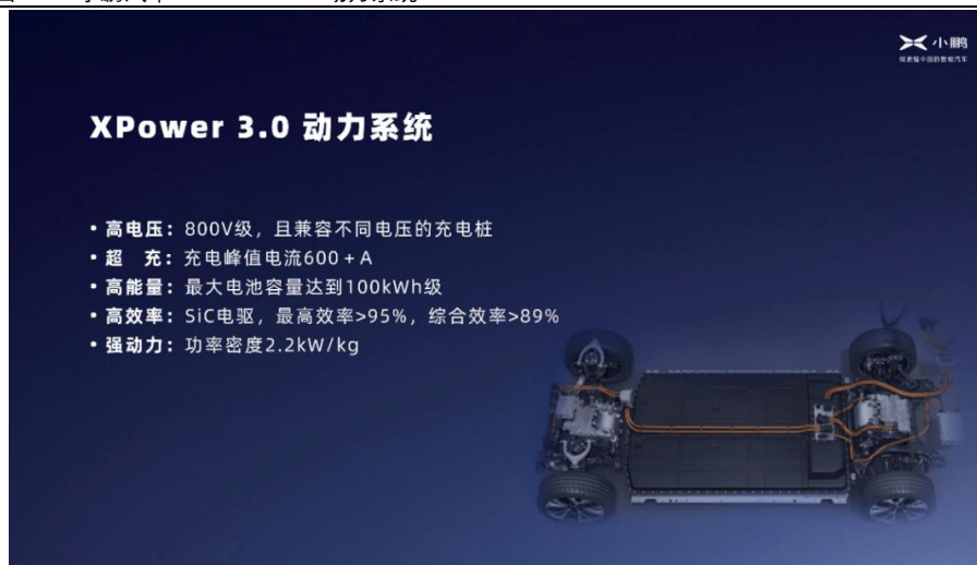
图 56: 小鹏汽车 XPOWER 3.0 动力系统
