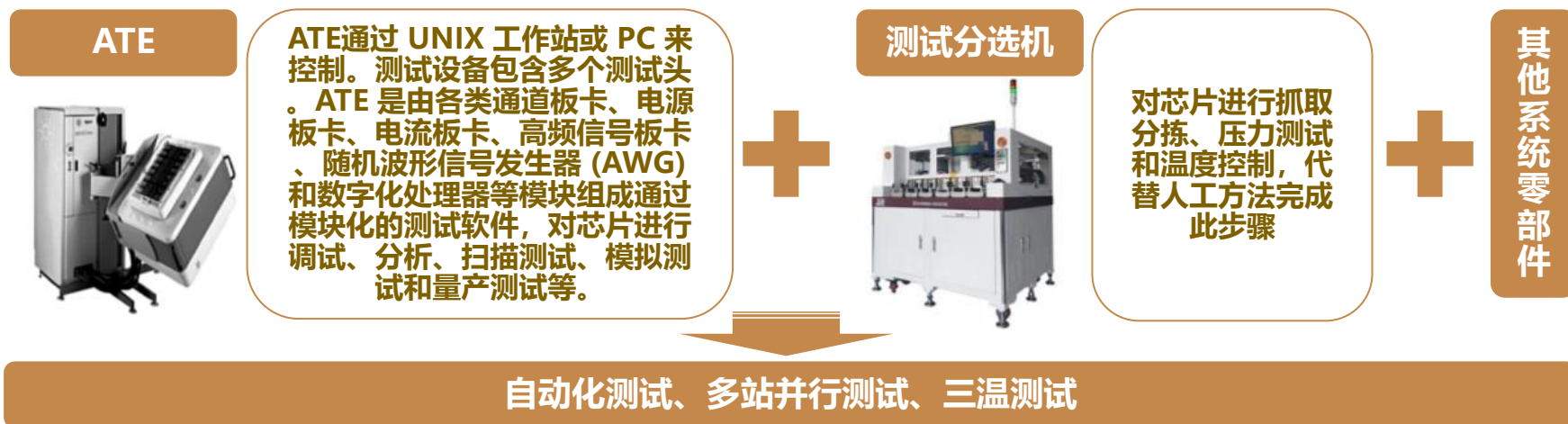
图表25：基于测试分选机的集成电路量产系统框图
