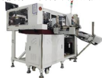
配备高兼容性上下料系统的测试分选机
