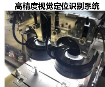
配备高兼容性上下料系统的测试分选机
