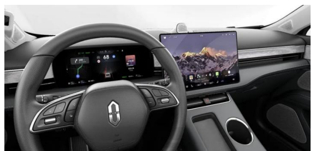
图22： 华阳为问界 M5 配套 10.25 寸高清液晶仪表
