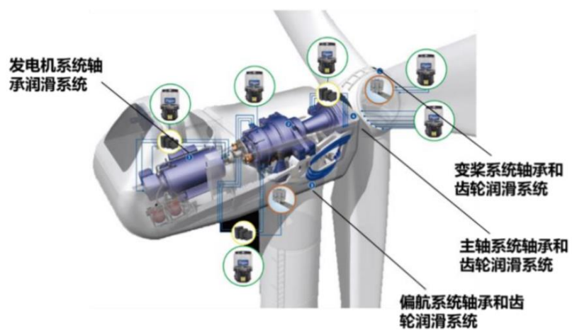
图17: 集中润滑系统为风机主轴、偏航、变桨、发电机等机械系统提供自动润滑
