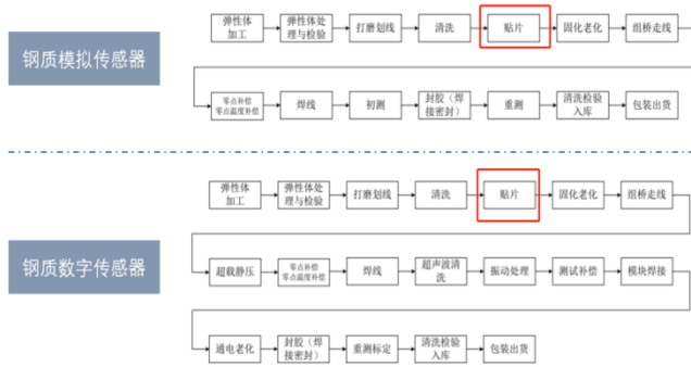
图表53: 钢质模拟传感器、钢质数字传感器生产流程
