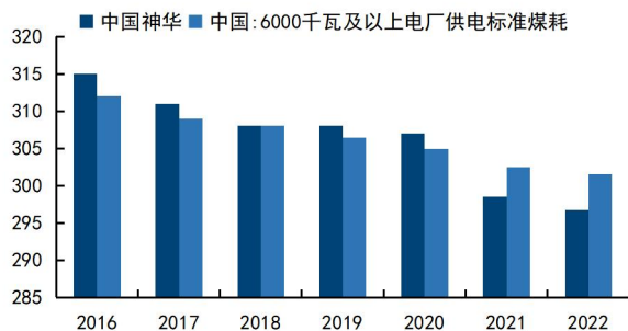
图19: 自 2021 年起公司供电煤耗低于全国平均 (gce/kWh)
