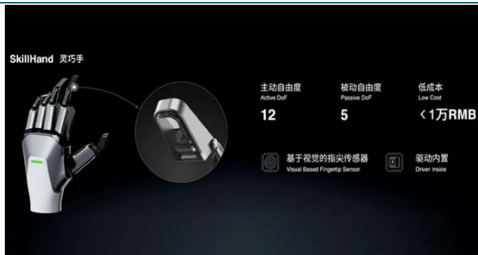
图表77：远征 A1 灵巧手拥有 12 个主动+5 个被动自由度
