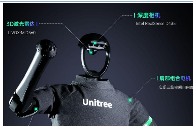
图表85: 宇树 H1 可实现自主避障和定位导航
