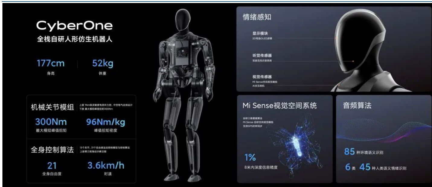
图表86：小米人形机器人 CyberOne 全身 21 个自由度，行走速度达 3.6km/h
