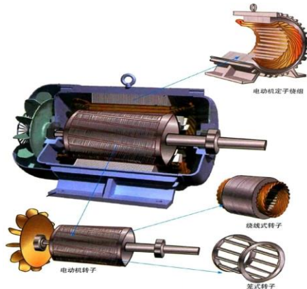
图表：交流电机结构图
