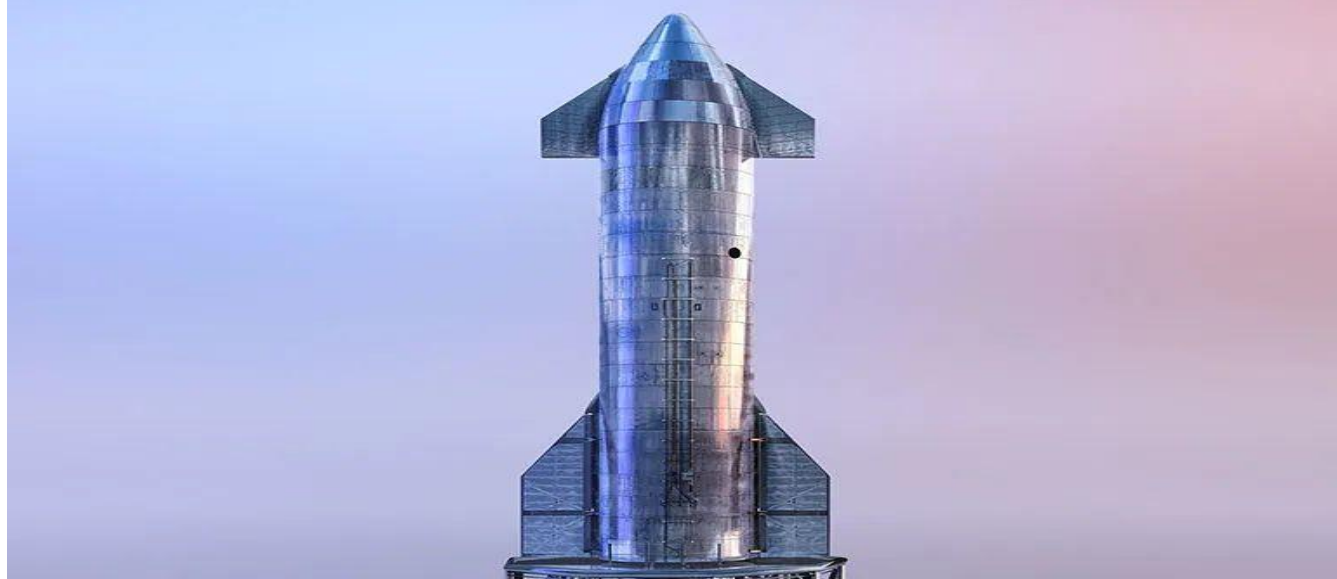
图31：不锈钢的卓越性能使星际飞船能够应对极高和极低温度
