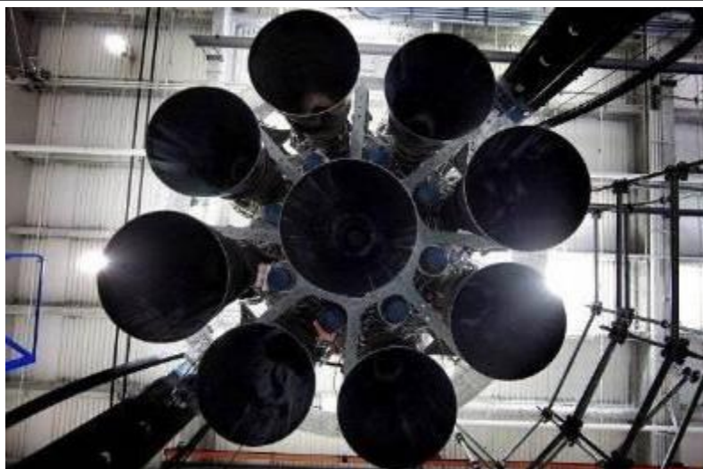
图33：猎鹰 9 号发动机螺接安装结构 OctaWeb
