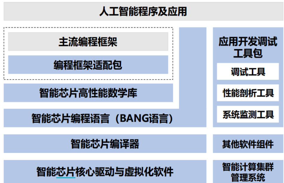
图 31：Cambricon Neuware 框架结构
