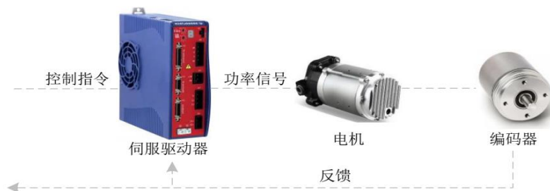
图14：伺服系统由伺服电机（内部集成编码器）和伺服驱动器构成
