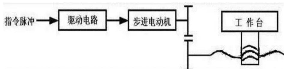
图13：开环控制的步进系统没有反馈回路
