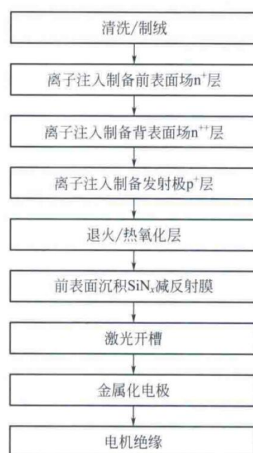
图 20：离子注入技术制备 IBC 太阳能电池的工艺流程
