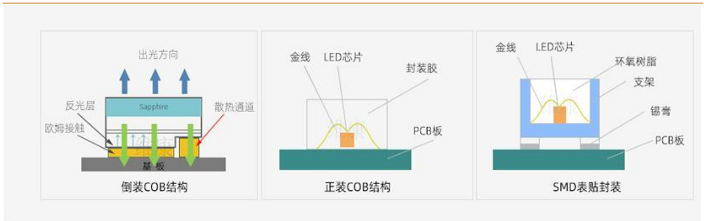
图 20: COB 封装和 SMD 封装的技术对比
