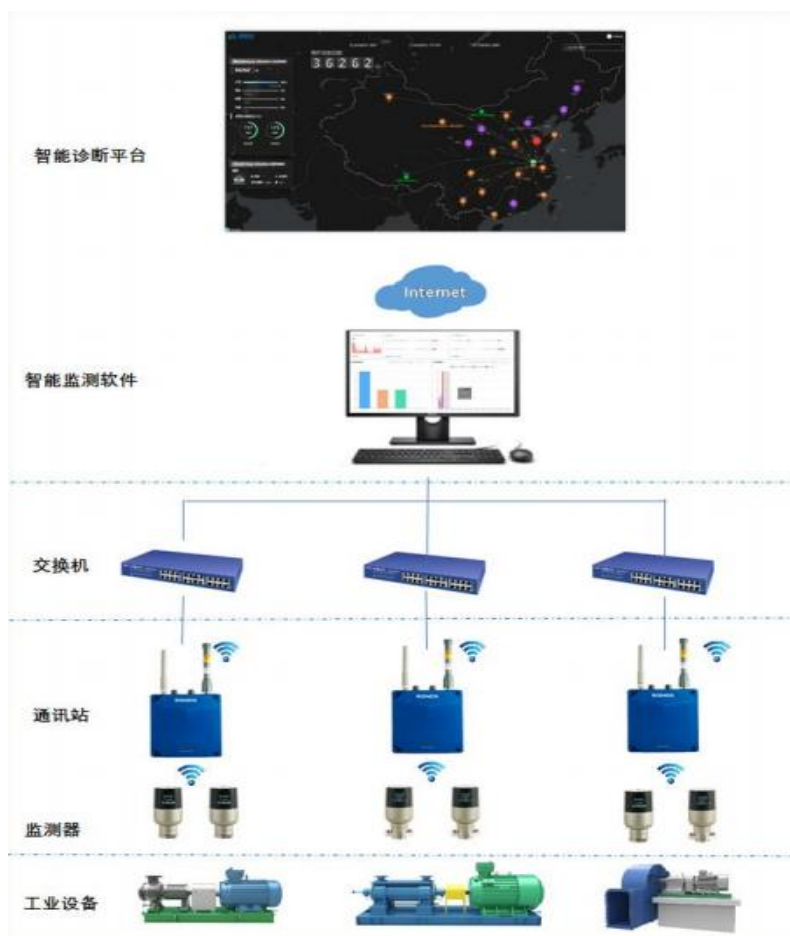
图表25: PHM 无线系统架构示意图
