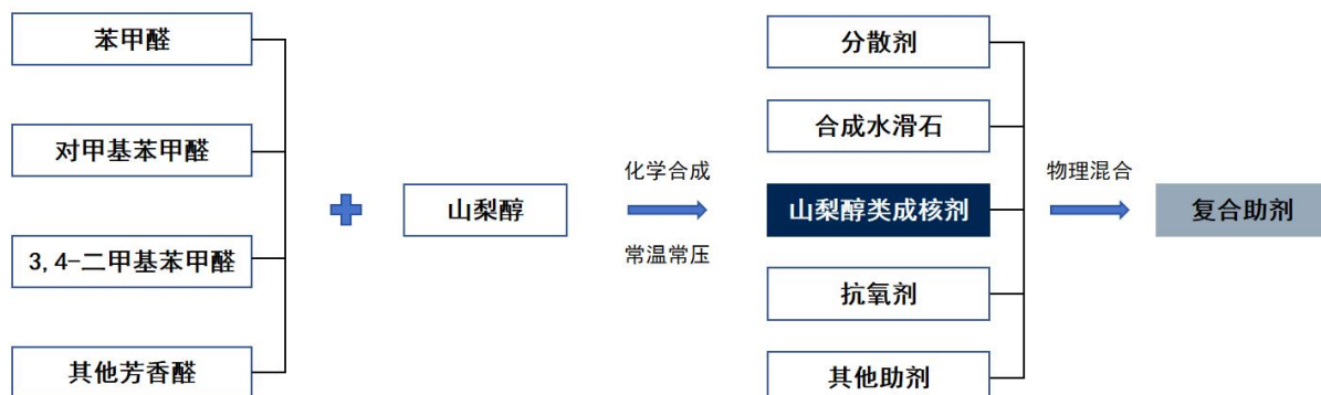
图13: 山梨醇类成核剂、复合助剂生产工艺流程图
