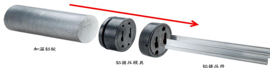
图17：铝挤压工艺示意图
