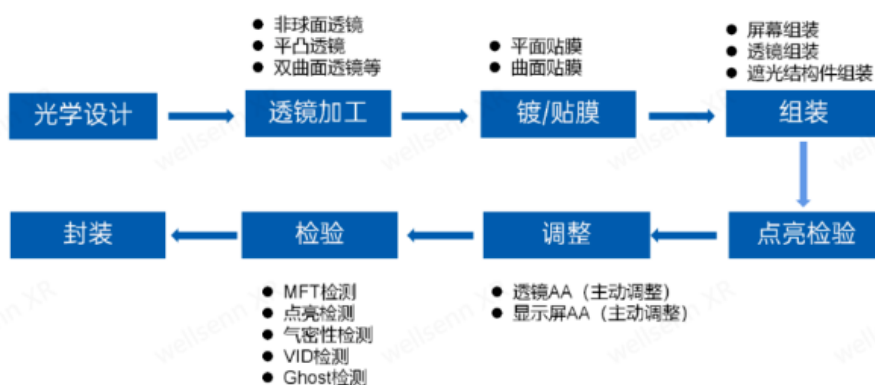
图13：Pancake 模组加工流程
