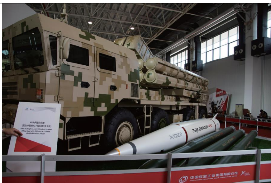
图26：AR-3火箭炮（PCH-191外贸版）的370和300毫米口径火箭炮共架发射车
