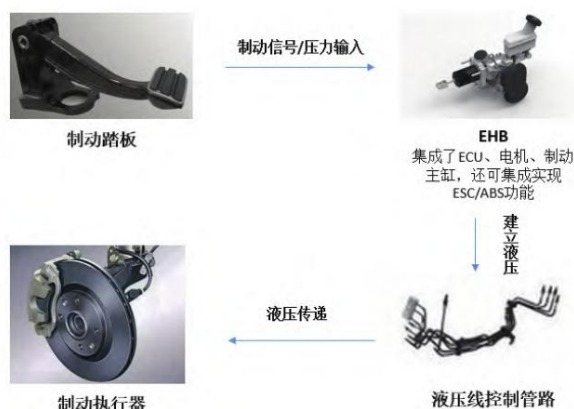
图 46：EHB 液压线控制动系统工作原理
