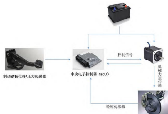
图 47：EMB 电子机械制动系统主要组成部分及原理
