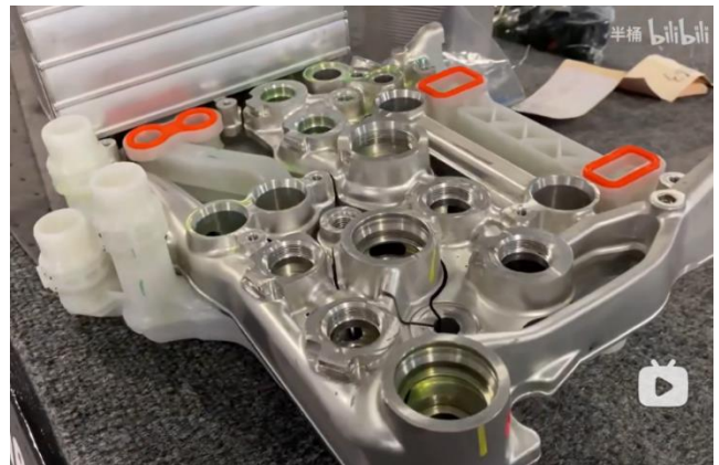
图29: Model Y 热泵中冷媒侧和水路侧的组件高度集成
