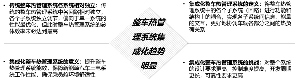
图24：整车热管理系统集成化趋势明显
