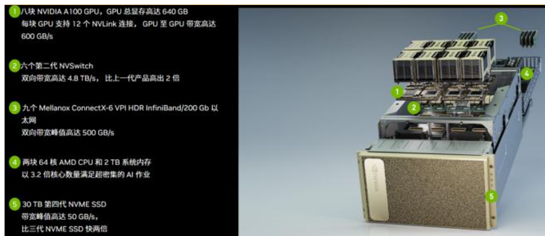
图 12：NVIDIA DGX A100 组件配置
