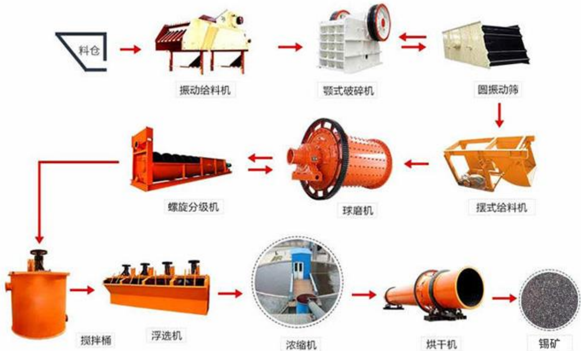
图表 9: 锡矿选矿工艺流程图
