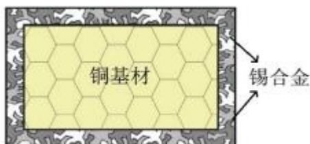
图表 11：光伏焊带横截面
