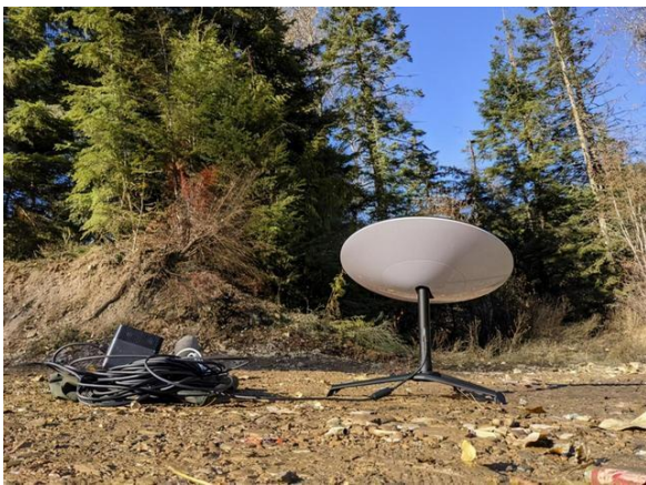
图13：安装在户外的地面接收器
