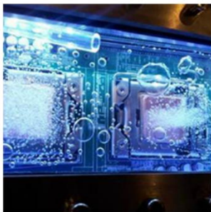
数据中心浸没式冷却
