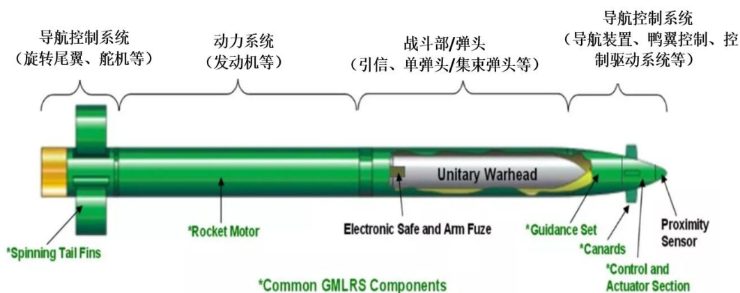
图 22: 远程火箭弹主要由制导控制系统、动力系统与战斗部组成
